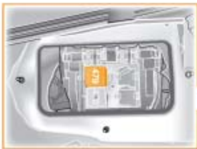
Trennrelais für CAN-Datenbus Antrieb J788
