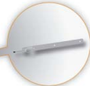
Antenne 3 im Innenraum für Zugang und Startberechtigung R154 – nur Limousine
