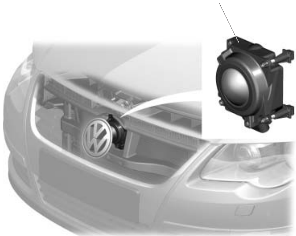
Steuergerät für Abstandsregelung J428 mit Sensor für automatische Distanzregelung G550
