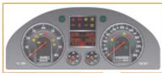
Steuergerät im Schalttafeleinsatz J285
