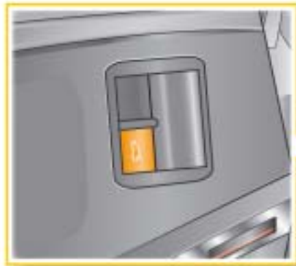
Taster für Fernentriegelung der Heckklappe E233
