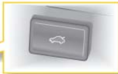
Taster für Schließung der Heckklappe im Kofferraum E406
