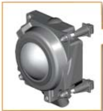
Steuergerät für Abstandsregelung J428 mit Sensor für automatische Distanzregelung G550
